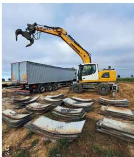
*Les composants sont découpés au format adapté pour pouvoir être transportés en camion et entrés dans le four des aciéries.*
