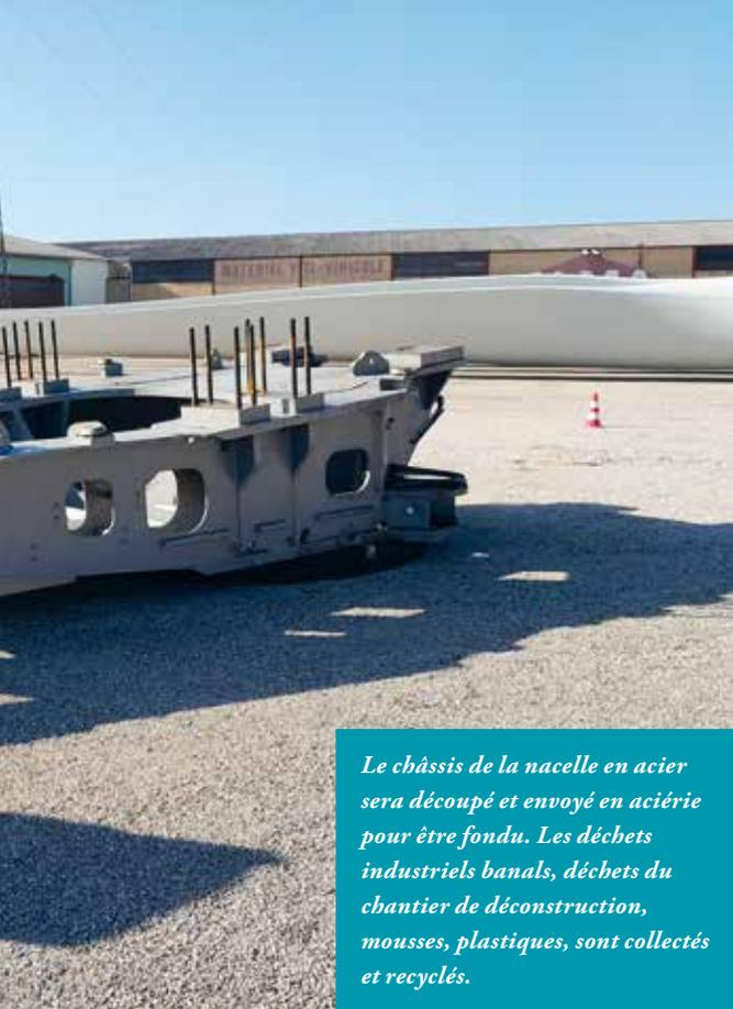
*Le châssis de la nacelle en acier sera découpé et envoyé en aciérie pour être fondu. Les déchets industriels banals, déchets du chantier de déconstruction, mousses, plastiques, sont collectés et recyclés.*
